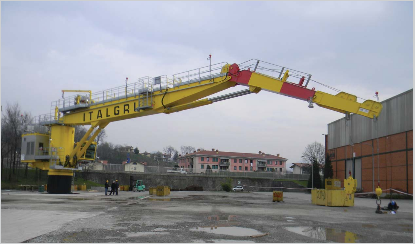
Knuckle Boom Crane Type TK 1800 DH - SBM - FPSO Cidade De Ilhabela
